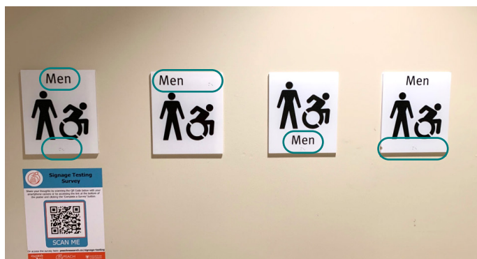
Figure 6 : Prototype de signalisation pour les toilettes testant l'emplacement du braille.
